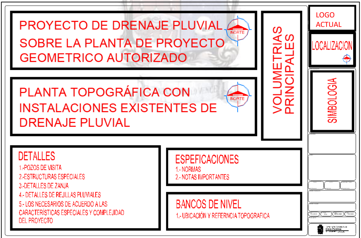
Fig. 16.07. Plano llave para proyecto de drenaje pluvial
