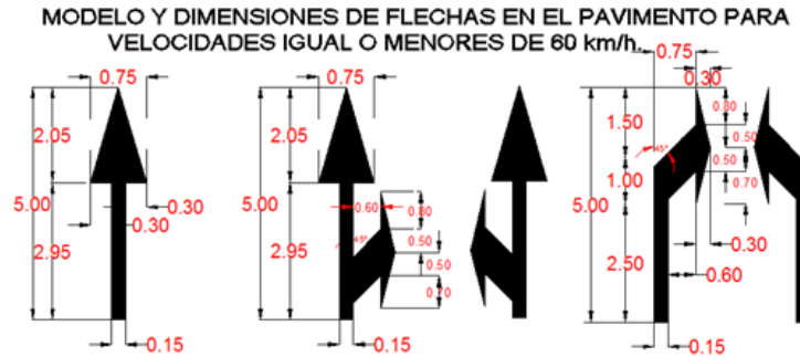
Fig. 9.08. Modelo y dimensiones de flechas en el pavimento para velocidades iguales o menores de 60 km/h.
