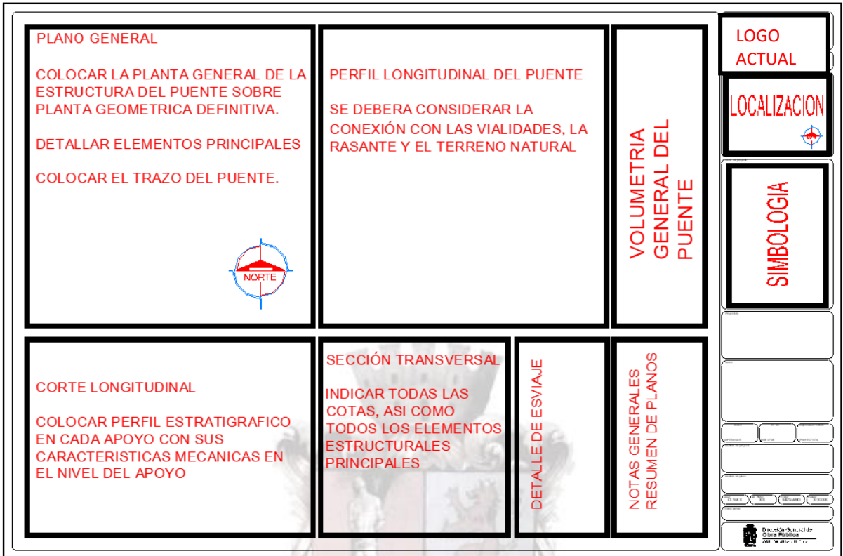
Fig. 16.18. Plano llave proyecto estructural - Puentes - Plano general
