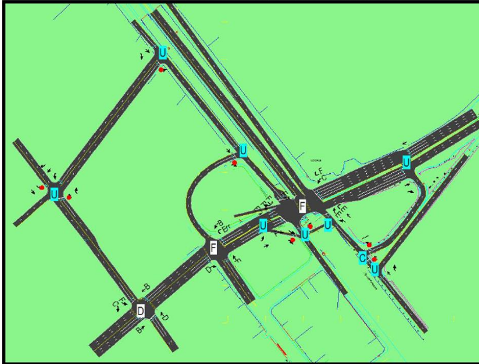
Fig. 2.11. Intersección simulada con niveles de servicio actuales.
